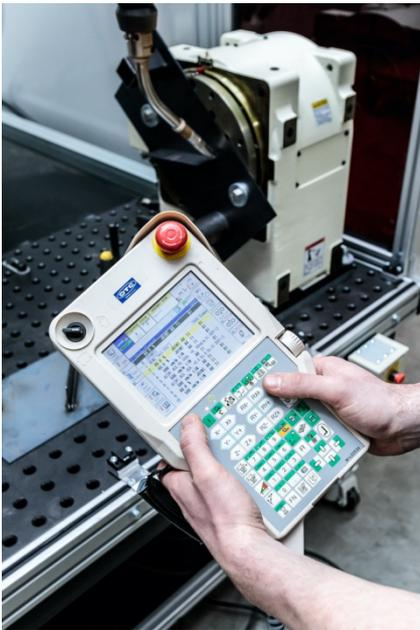
*Bedienfeld der Schweißroboterzelle. Die Easy Arc lässt sich wahlweise auch mit Positionierer ausstatten (rechts im Hintergrund).*
