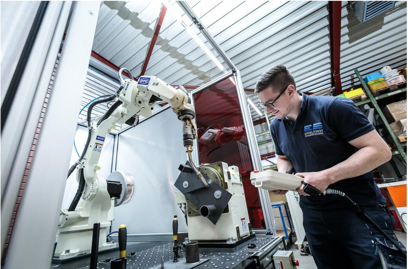
*Der Bediener der Easy Arc Schweißroboterzelle von OTC, Norman Schäfer, beim Teachin des Schweißverlaufs: „Die Programmierung geht mit ein wenig schweißtechnischer Erfahrung leicht von der Hand“.*
